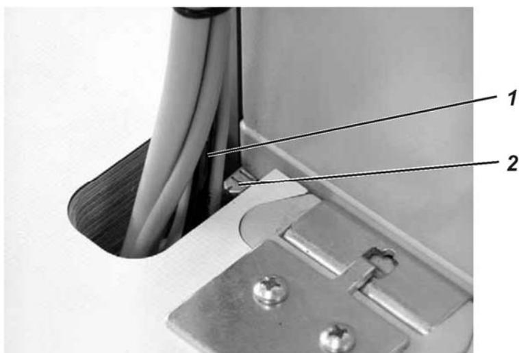
Заземляющий провод **1** находится в комплекте деталей машины.
