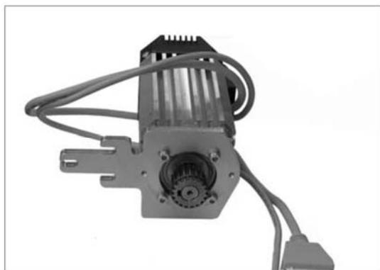
Позиция держателя мотора для монтажа швейной головки под наклоном
