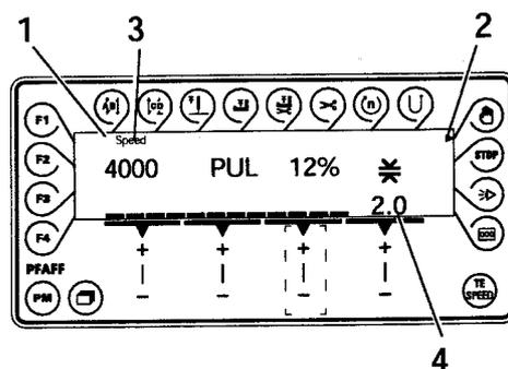
Пульт состоит из дисплея 1 и из описанных ниже функциональных клавиш. Дисплей 1 состоит из двухстрочного буквенно-цифрового индикатора, в каждой строчке по 16 знаков. Тексты 3 указывают соответствующий статус функциональной клавиши и режимы работы машины.
