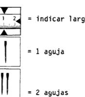
2.2 Para los ribeteadores hay que indicar el ancho de la cinta, para las garniciones de 2 agujas, la distancia entre agujas, y para los elementos de corte, la distancia de corte.
