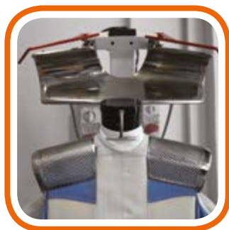
Устройство для глажки кокетки. Device for yoke ironing.
