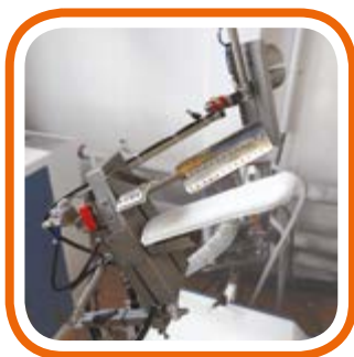
Регулируемые и натяжные зажимы с автоматическим застегиванием манжет и рукавов. Adjustable and tensioning with automatic closure of cuffs and sleeve.
