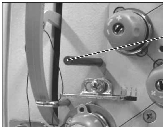
Стопорной штифт 1 серийно прилагается к швейной машине. Он находится в дополнительной коробке с комплектующими. При необходимости крепится на нижней стороне масляного резервуара, в месте, удобном для доступа.
