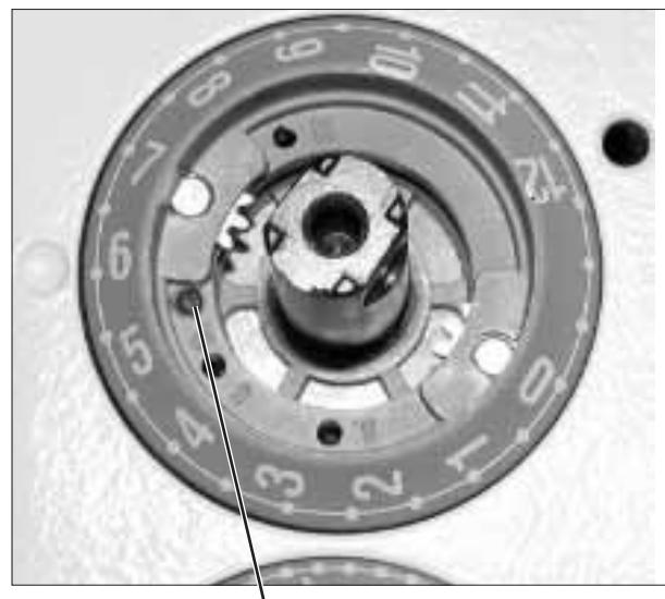
В зависимости от используемой оснастки ограничитель длины стежка должен быть установлен на 6, 9 или 12 мм.
