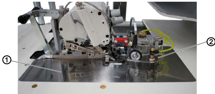
Fig. 6: Снятие и установка подвижной пластины для ткани (1)
