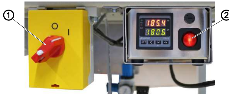
Fig. 23: Включение станции приклеивания
