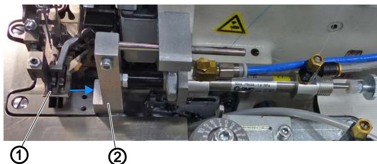
Fig. 10: Пневматическая направляющая края (опция) (2)
