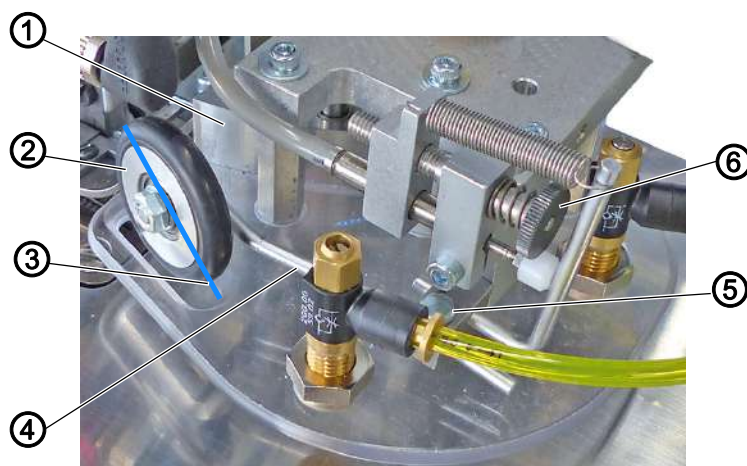
Fig. 12: Регулировка вспомогательного ролика
