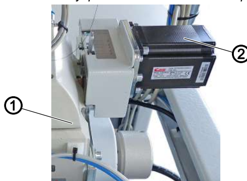
Fig. 13: Распределение посадки управляемое шаговым мотором (1)
