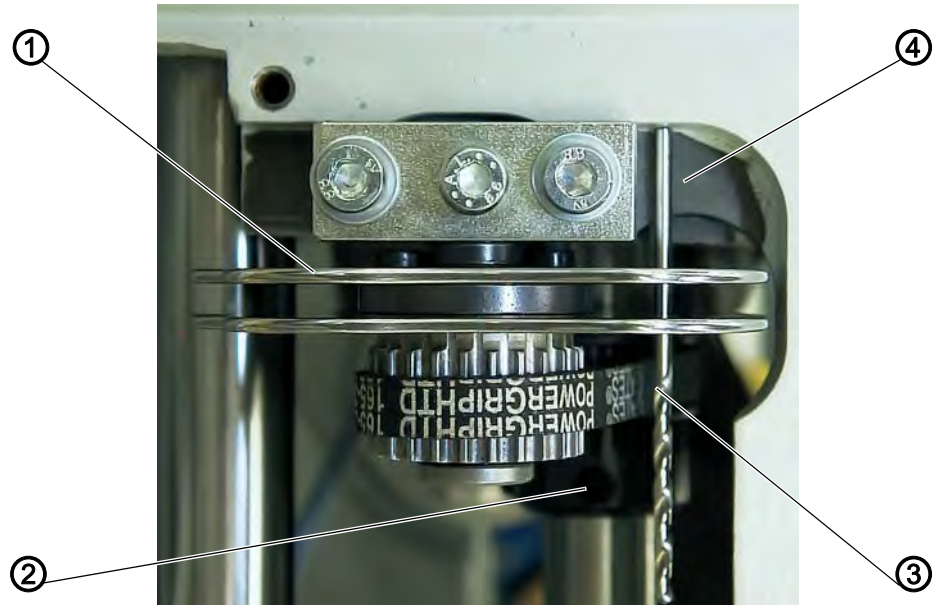
Fig. 4: Установка диска нитепритягивателя (1)
