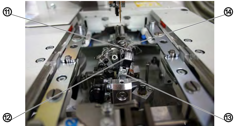
Fig. 83: Установка ножа обрезки игольной нити (5)
