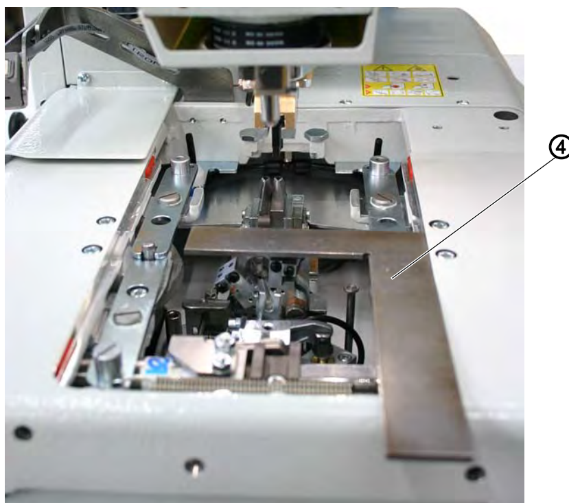
Fig. 15: Юстировка опоры петлителя(4)
