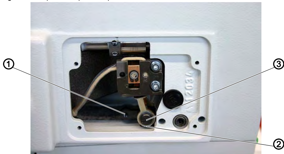
Fig. 41: Настройка ширины строчки зиг-заг
