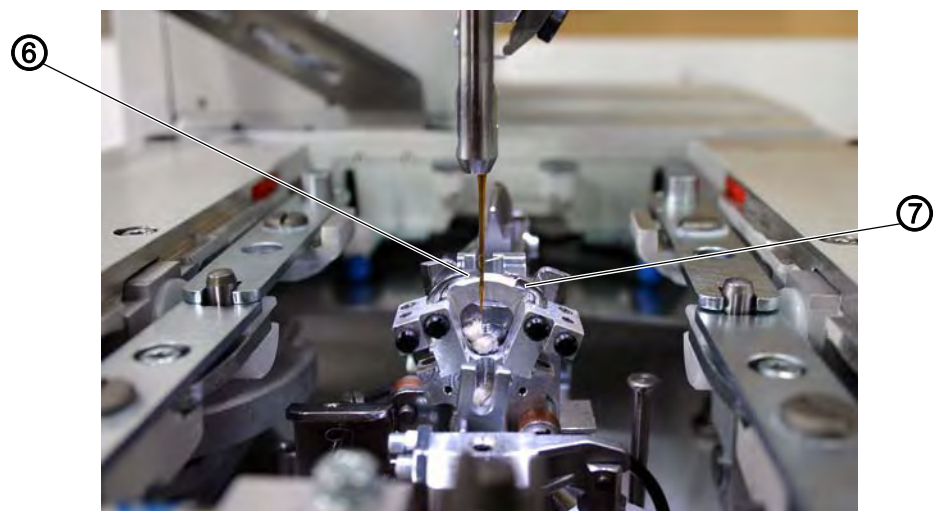
Fig. 67: Настройка высоты захвата петли (4)
