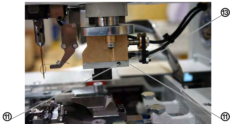
Fig. 56: Установка колодки, multiflex (3)
