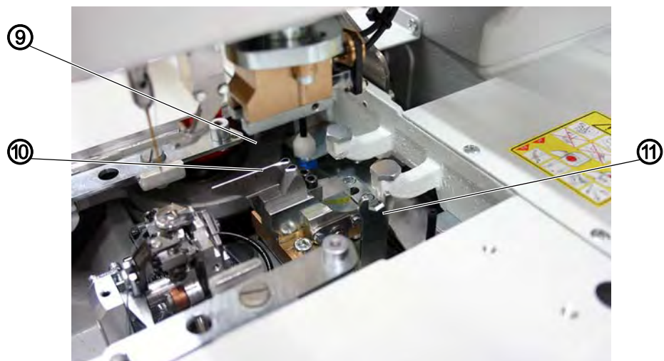
Fig. 52: Установка ножа, multiflex (2)
