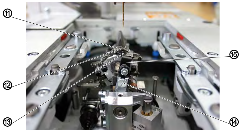
Fig. 113: Настройка зажима нити петлителя (3)
