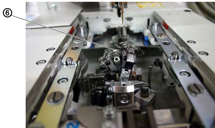
Fig. 81: Установка ножа обрезки игольной нити (3)
