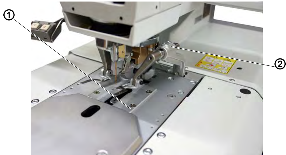
Fig. 35: Фиксация зажимных пластин (1)
