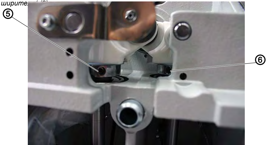
Fig. 3: Установка эксцентриков петлителя и ширителя (2)
