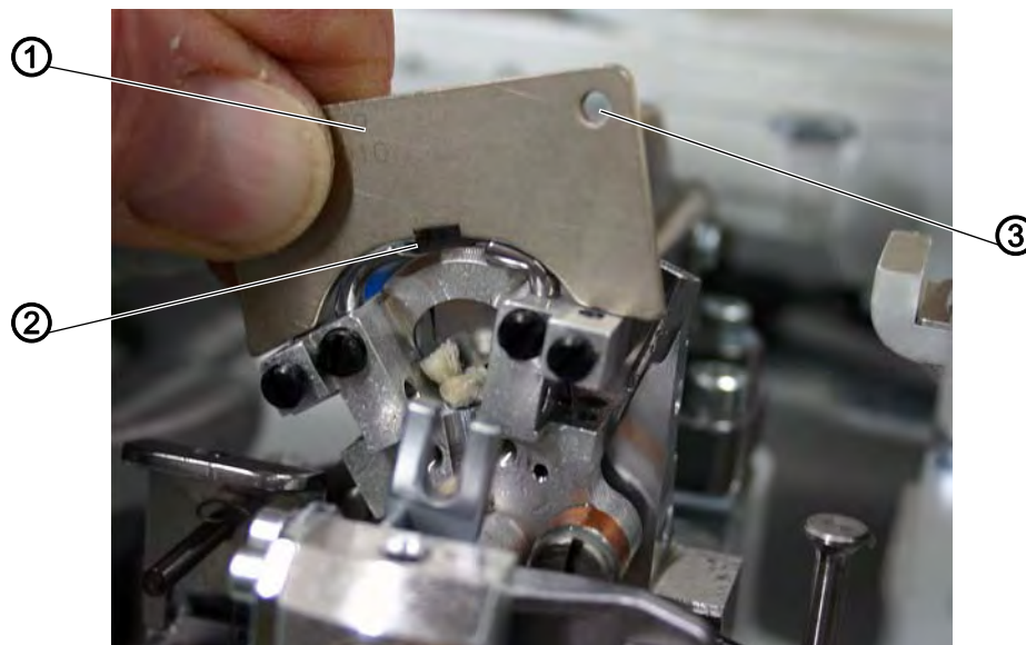
Fig. 63: Установка высоты петлителя
