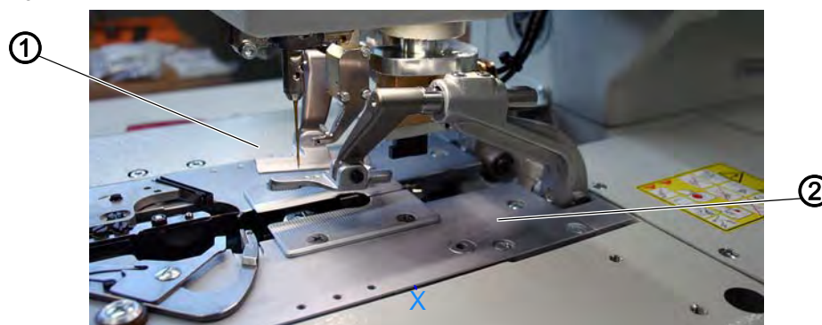
Fig. 30: Зажимные пластины, установка раздвижки (1)
