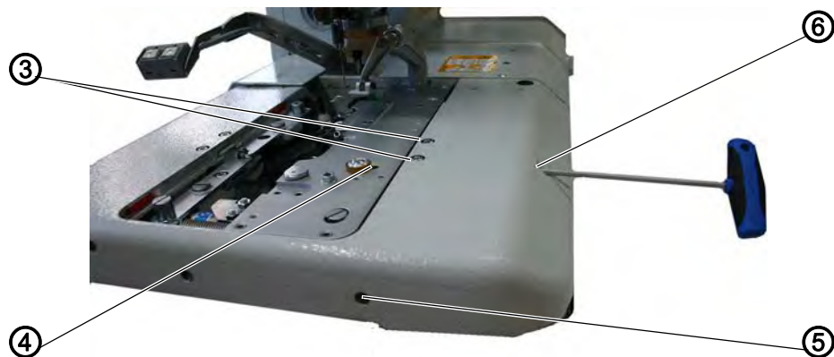
Fig. 31: Зажимные пластины, установка раздвижки (2)
