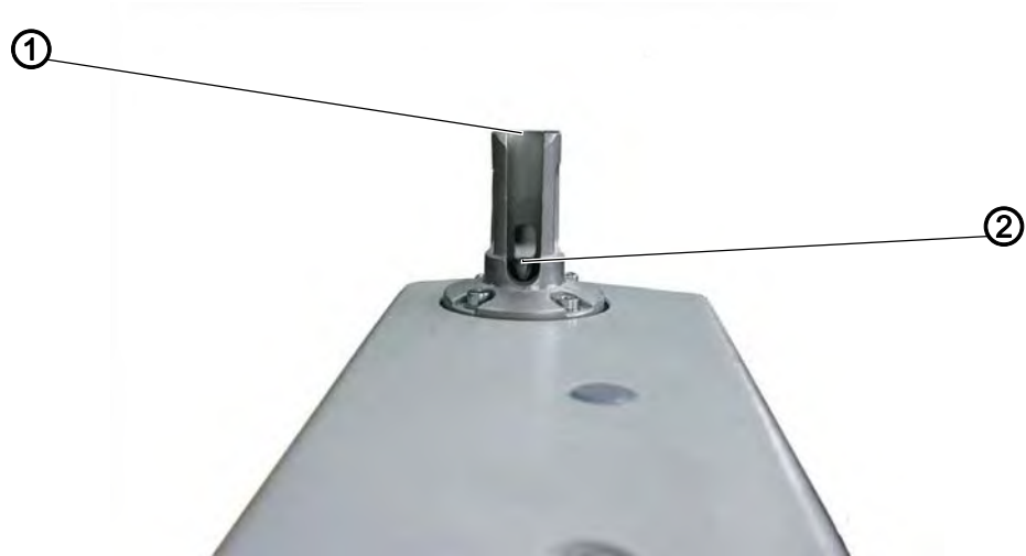
Fig. 64: Настройка высоты захвата петли (1)
