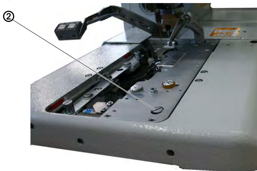
Fig. 29: Выравнивание зажимных пластин (2)
