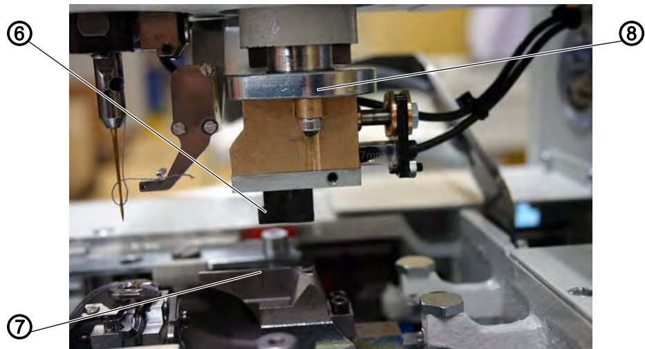
Fig. 54: Установка колодки, multiflex (1)
