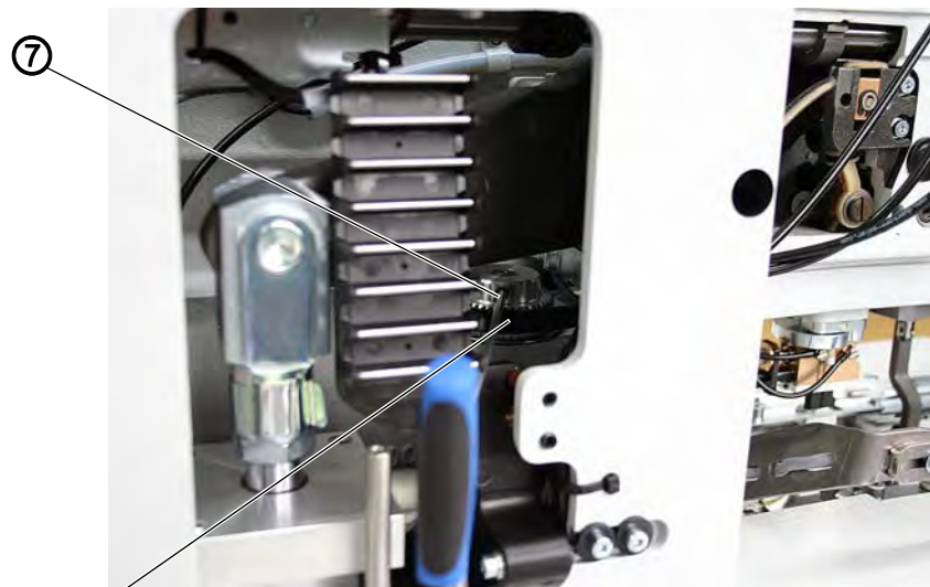
Fig. 19: Юстировка игловодителя параллельно опоре петлителя(4)
