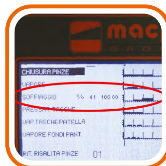
Регулировка количества воздуха с помощью инвертора Regulatable blowing power with in- verter
