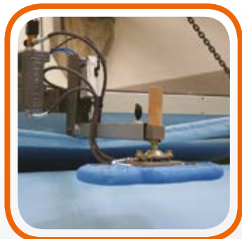
Глажка воротников/этикеток паром в одинарном или двойном режиме. Single or double collar/label ini-sher (steaming)
