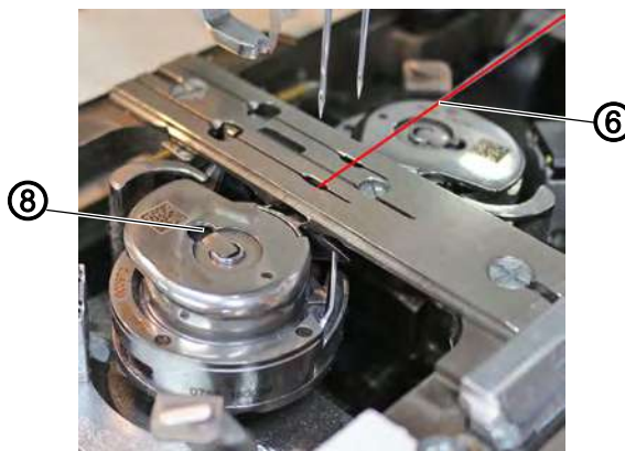
Fig. 15: Регулировка натяжения нити челнока и силы тормоза шпули (4)
