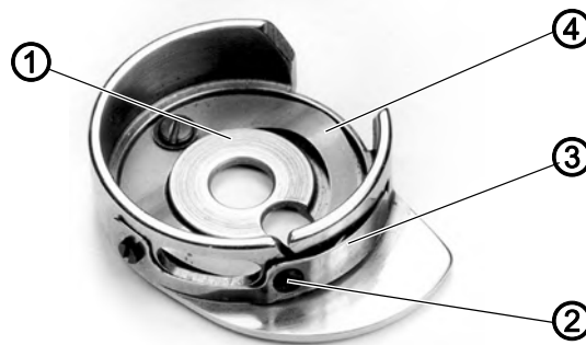
Fig. 12: Регулировка натяжения нити челнока и силы тормоза шпули (1)
