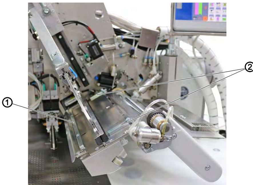
Fig. 32: Укладка двухсторонней обтачки
