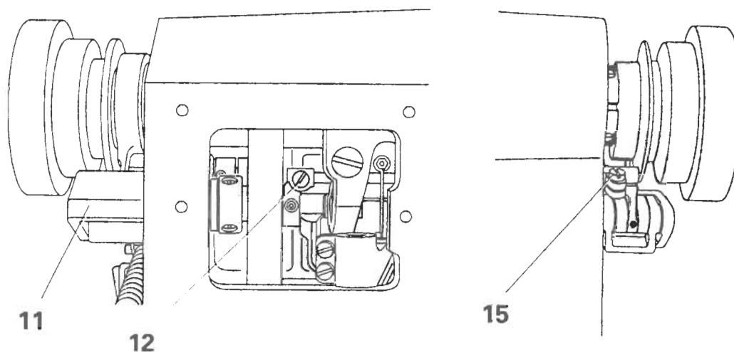
**Правило:** При максимальной длине стяжка и в положении стержня игловодителя на 0.6 мм выше верхней мертвоточки (регулировочное отверстие "1") верхний транспортер 3 не должен двигаться в процессе движения рычага переключения стяжка вниз и вверх.
