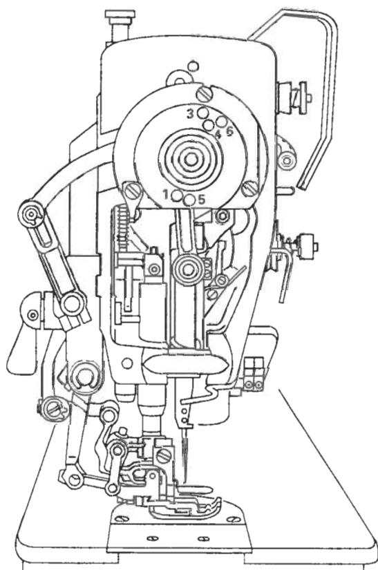
РЕГУЛИРОВОЧНОЕ ОТВЕРСТИЕ 1 = 0.6 мм выше верхней мертвей точки стержня игловодителя
