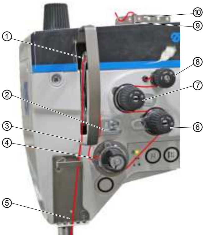
Fig. 6: Заправка игольной нити на 1-игольных машинах (1)
