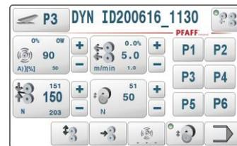
В том случае, если работа часто требуется выполнять с минимальными пределами, а непреднамеренная остановка нежелательна, отключение можно предотвратить с помощью параметра Dynstop = 1.
