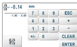
Величина зазора относительно положения нулевого усилия сонотрода можно ввести, нажав сенсорное поле зазора на экране ручной сварки.
