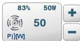
Если рядом с полем ввода есть клавиши **+** **-** их можно использовать для пошагового увеличения или уменьшения параметров сварки. (Ввод значения может быть отключен в определенных рабочих состояниях.)
