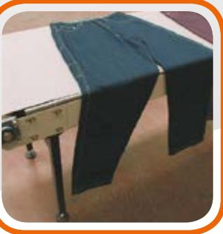
Автоматическая система разгрузки размещает выглаженные изделия на конвейерной ленте поштучно или в пачках
