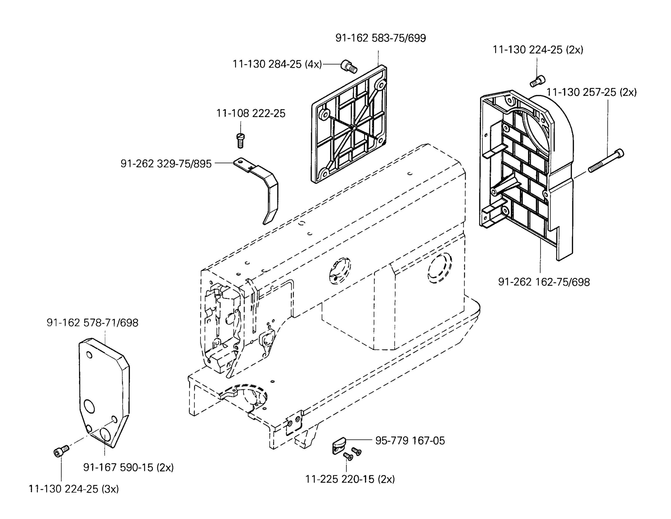
Kopfteile Needle head parts Pièces de tête
