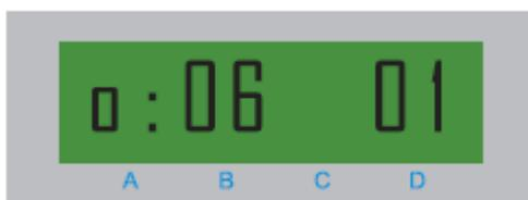
С помощью параметра 01 Вы устанавливаете значение сброса для счетчика стежков шпули A.
