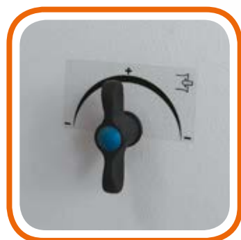
Регулировка мощности всасывания. blowing suction power regulation.
