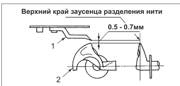
Согните разделительный заусенец 1, используя отвертку или аналогичный инструмент, и отрегулируйте таким образом, чтобы расстояние между заусенцем разделения нити 1 и петлителем 2 составляло от 0.5 до 0.7 мм.
