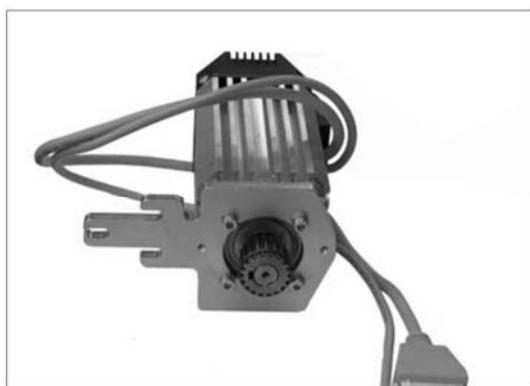
Позиция держателя мотора для монтажа швейной головки под наклоном
