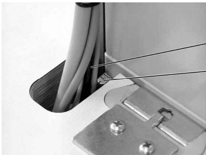
Заземляющий провод **1** находится в комплекте деталей машины.
