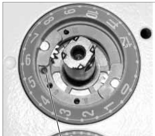
В зависимости от используемой оснастки ограничитель длины стежка должен быть установлен на 6, 9 или 12 мм.
