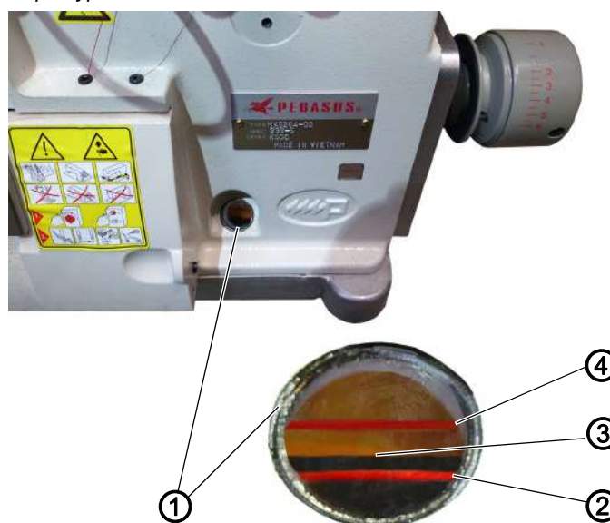
Fig. 98: Проверка уровня масла головки машины
