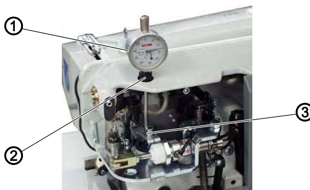
Fig. 32: Установка уклонения иглы (1)
