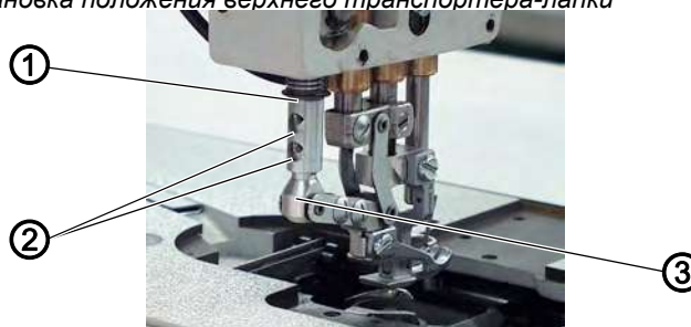
Fig. 62: Установка положения верхнего транспортера-лапки
