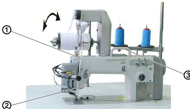
Fig. 1: Опрокидывание и подъем головки машины
