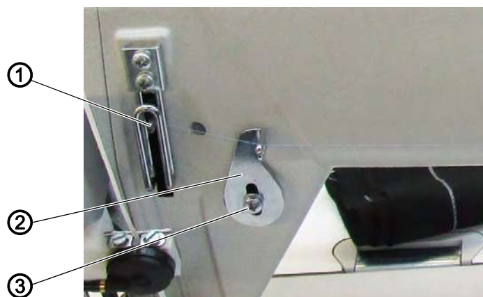
Fig. 77: Регулировка нитенаправителя на рукаве машины
