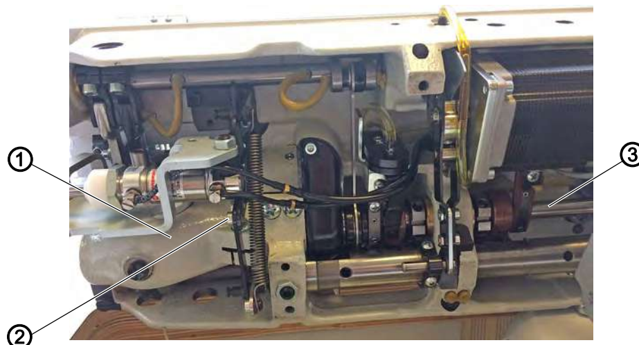
Fig. 26: Снятие и установка корпуса привода петлителя
