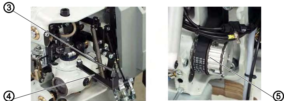
Fig. 36: Настройка симметрии движения петлителя (2)
