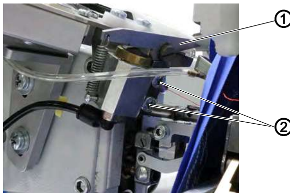
Fig. 83: Настройка позиции ножниц для обрезки ленты
