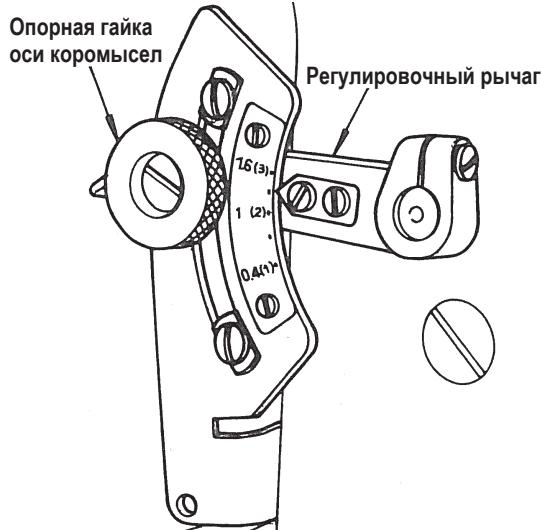
Ослабьте контргайку рычага регулировки и наладьте угол рычага; потяните вверх, рычаг для стежков сбиравания в сборки и надавите вниз его для пошива тянувшихся тканей. Иллюстрации на круговой шкале дифференциальной подачи показывают отношение вспомогательной подачи к основной подаче.
