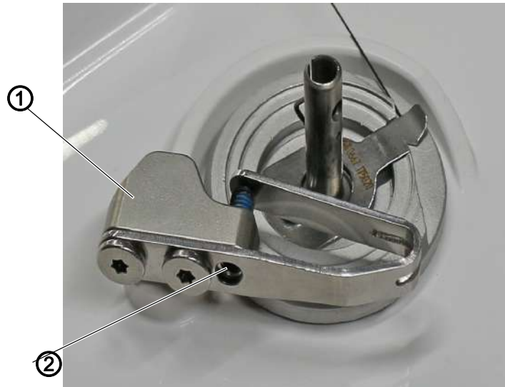
Fig. 62: Регулировка количества намотки нити
