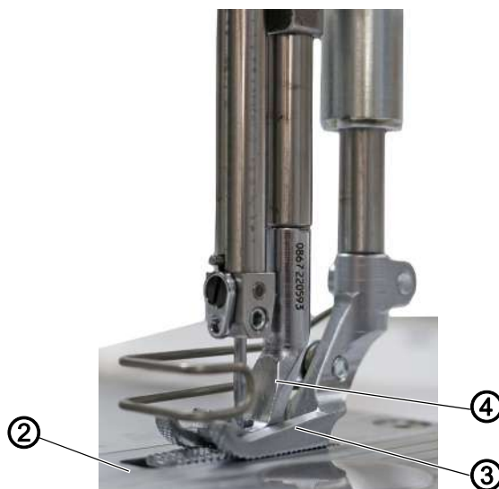
Fig. 55: Регулировка давления и подъема швейных лапок (2)
