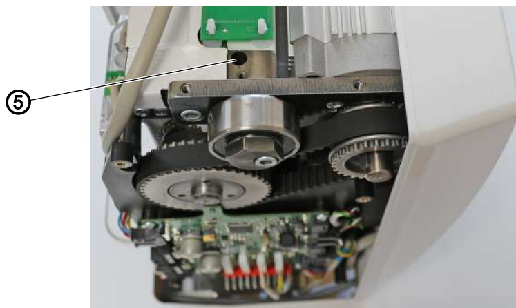
Fig. 49: Регулировка механизма подъема лапок(3)
