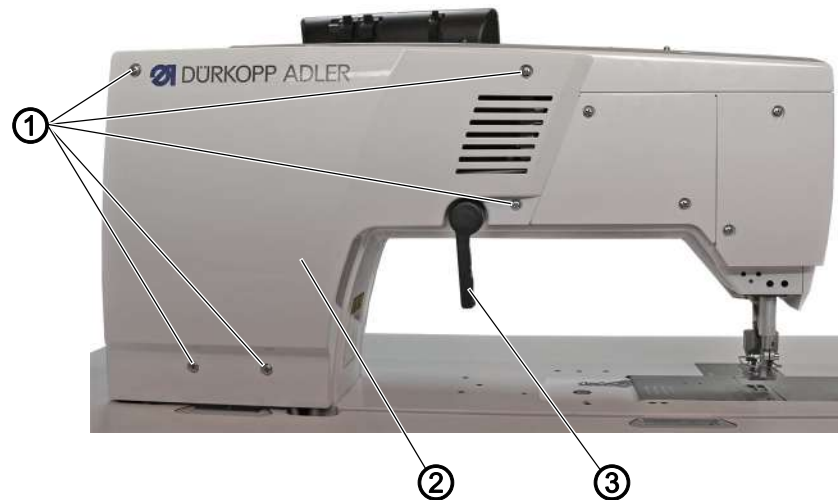
Fig. 10: Демонтаж и монтаж крышки двигателя
