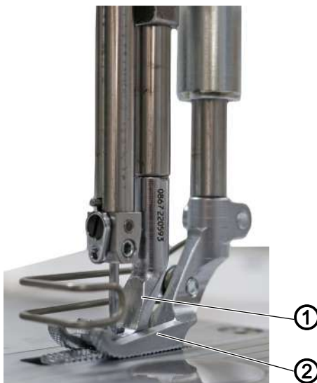
Fig. 52: Настройка равномерного хода швейных лапок (1)
