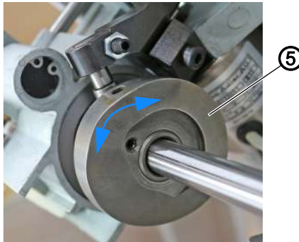
Fig. 75: Настройка времени обрезки нитей: (2)
