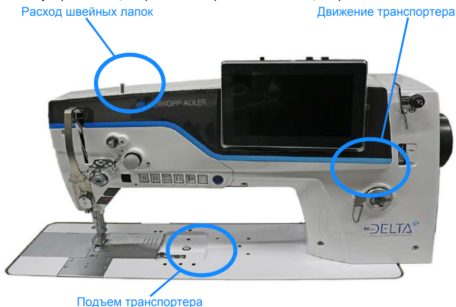
Fig. 24: Регулировка эксцентриков - обзор положений эксцентриков
