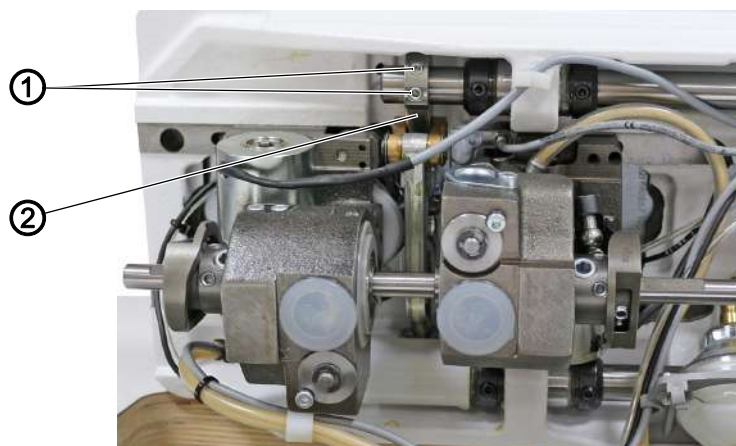
Fig. 37: Регулировка высоты подъема транспортера в В.М.Т.
