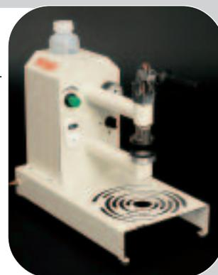
станция для проверки сварного шва
