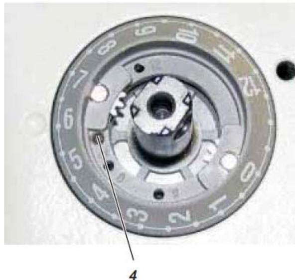
В зависимости от используемой оснастки, ограничитель длины стежка должен быть установлен на 6 или 9 мм.
