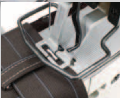
Maksymalne wymiary rygla w maszynie 3771 to 40 x 20 mm.
