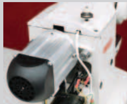
Silnik „synchro” o dużej mocy, umieszczony przy głowce sprawia, że maszyna pracuje cicho i bez wibracji.
