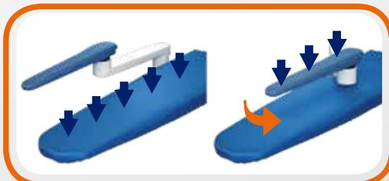
Автоматическое управление для перенаправления воздушного потока от стола к поворотному рычагу.
