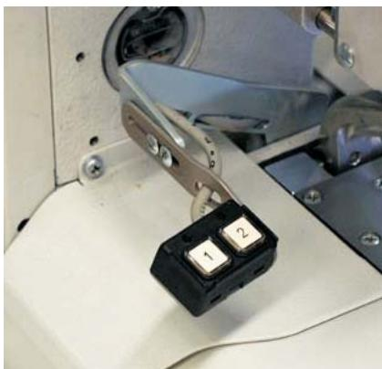
При помощи ручного переключателя может производиться управление зажимами и запуск швейной операции. В зависимости от соответствующей установки в сервисном меню (см. Руководство по техническому обслуживанию) может иметь различные функции.
