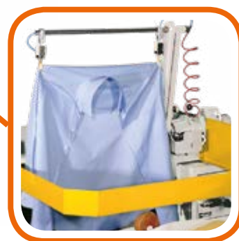
965.01 АВТОМАТИЧЕСКИЙ РАЗГРУЗЧИК. Состоит из подвижной руки, которая удерживает рубашки и перемещает их к опоре, управляемой синхронным двигателем мощностью 0,24 кВт. 965.01 AUTOMATIC UNLOADER Composed by a movable arm, which holds the shirts and brings them to the support, controlled by a ratiom- otor 0,24 Kw.
