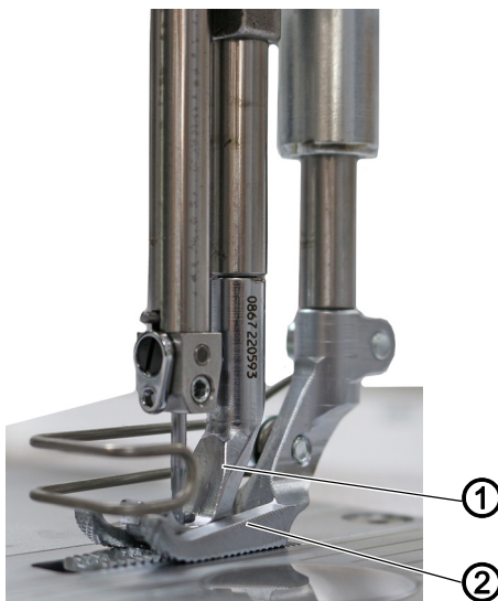
Fig. 52: Настройка равномерного хода швейных лапок (1)
