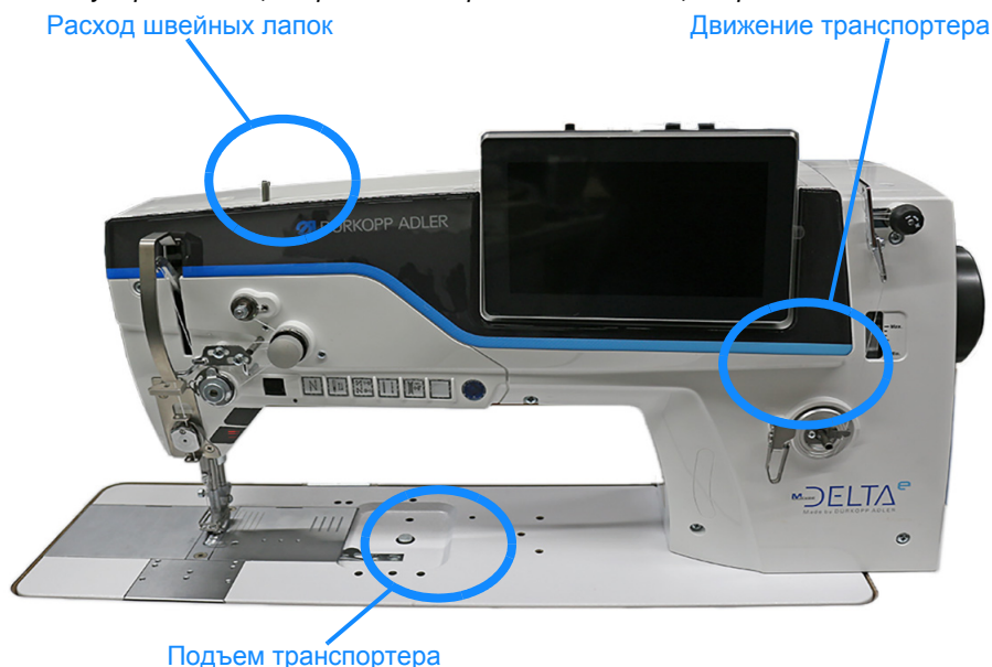
Fig. 24: Регулировка эксцентриков - обзор положений эксцентриков
