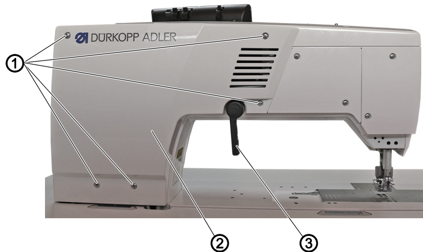
Fig. 10: Демонтаж и монтаж крышки двигателя
