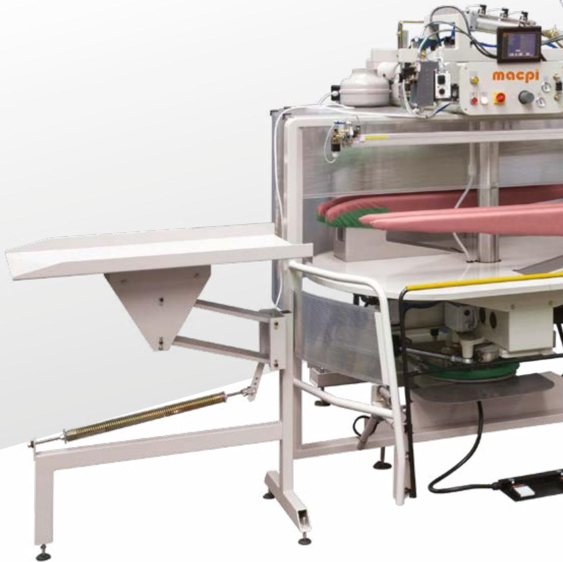
Сбалансированная зона загрузки, обеспечивающая постоянную высоту (H) укладки.
