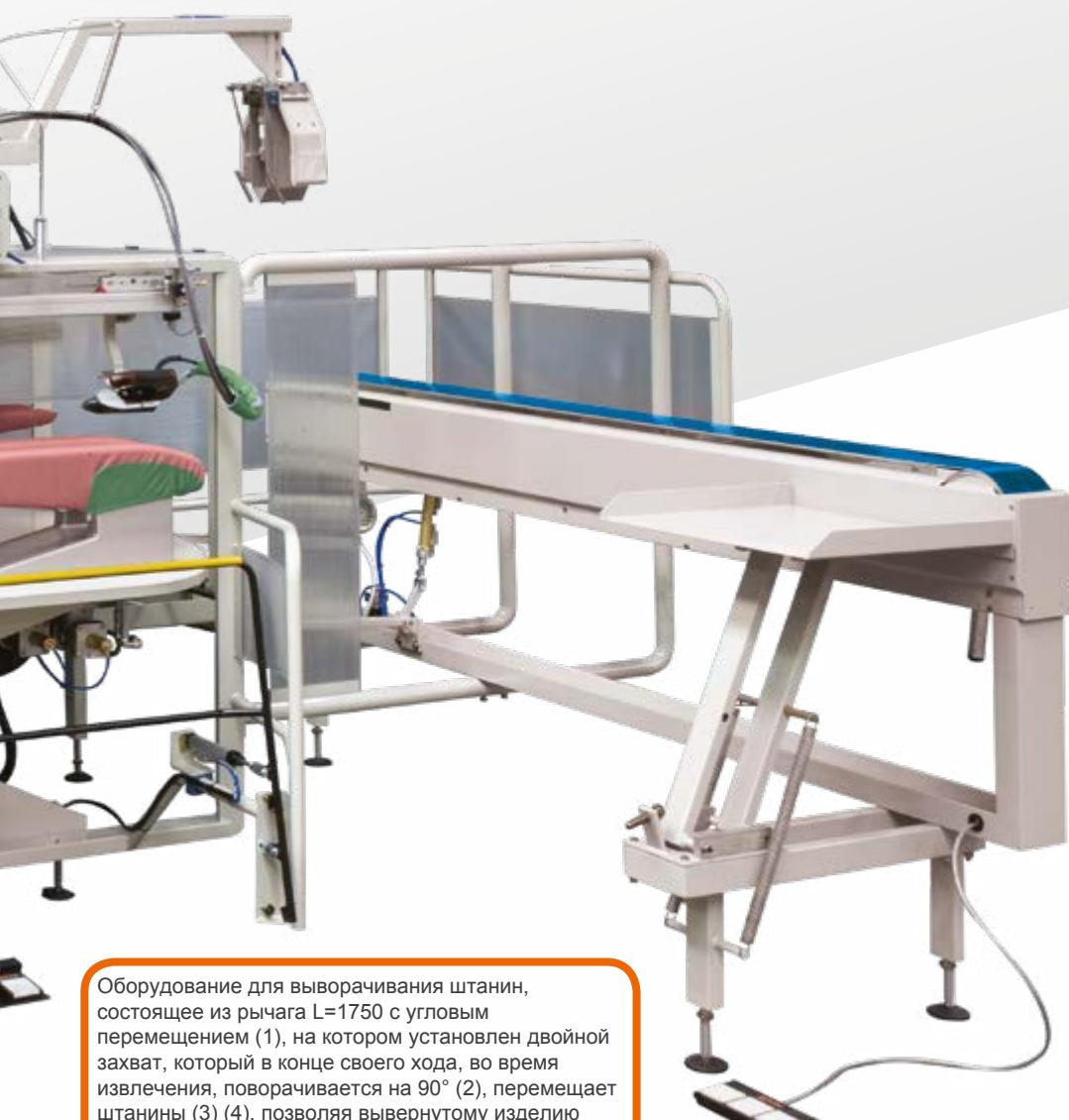
Оборудование для выворачивания штанин, состоящее из рычага L=1750 с угловым перемещением (1), на котором установлен двойной захват, который в конце своего хода, во время извлечения, поворачивается на 90° (2), перемещает штанины (3) (4), позволяя вывернутому изделию быть размещенным на конвейере для поштучного или пакетного накопления (5).
