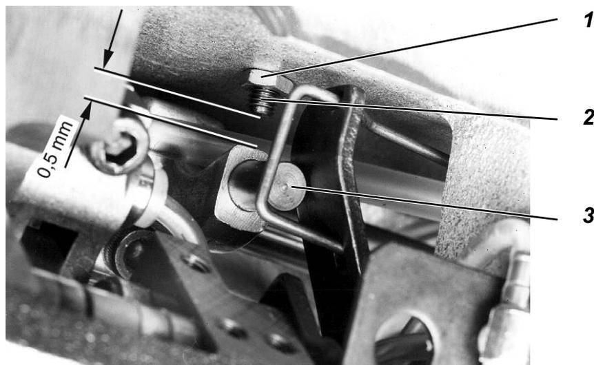
Упорный винт 2 ограничивает подъем лапок, если коленный рычаг полностью отводится вправо. Тем самым предотвращается соударение лапок с игловодителем.
