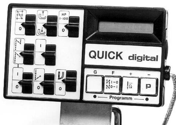
Швейные машины с панелью управления “ **QUICK** ” следует регулировать по этому методу .
