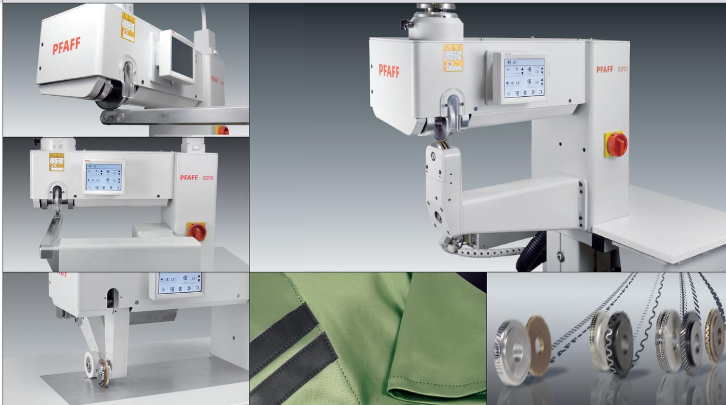
**Programmierbare Ultraschall-Schweißmaschine mit Rollsonotrode (Premium-Version)**
